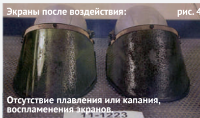
Отсутствие плавления или капания, воспламенения экранов.
